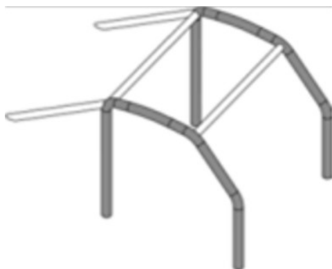
Figur 2. Grundkonstruktion av skyddsbur typ 2.
