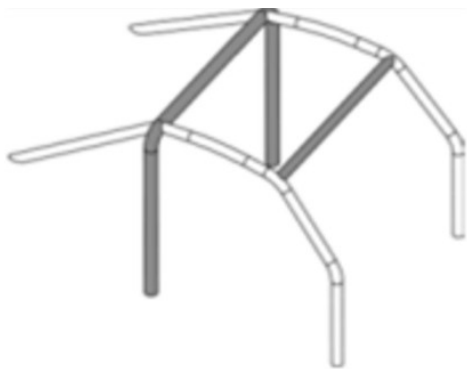
Figur 3. Grundkonstruktion av skyddsbur typ 3.
