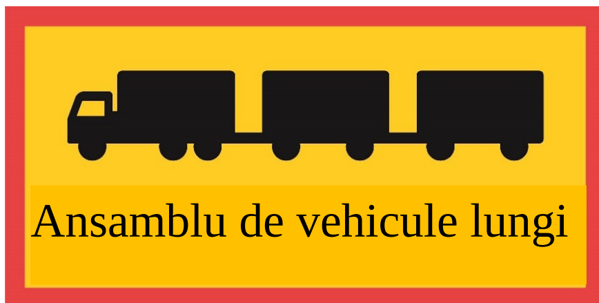
Figura 1. Designul marcajului pentru un ansamblu de vehicule lungi.
