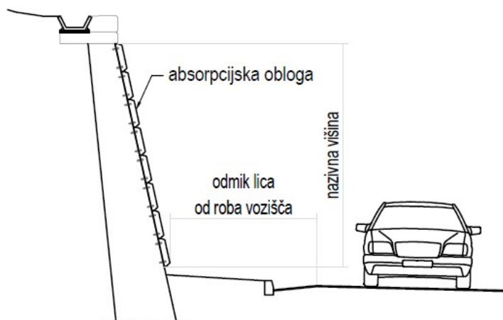
Slika 14: Protihrupna obloga na opornem zidu
