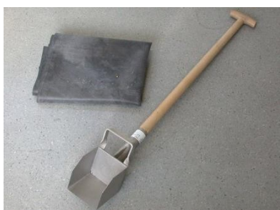
Figuur 1: bemonsteringsschep met rechtopstaande rand
