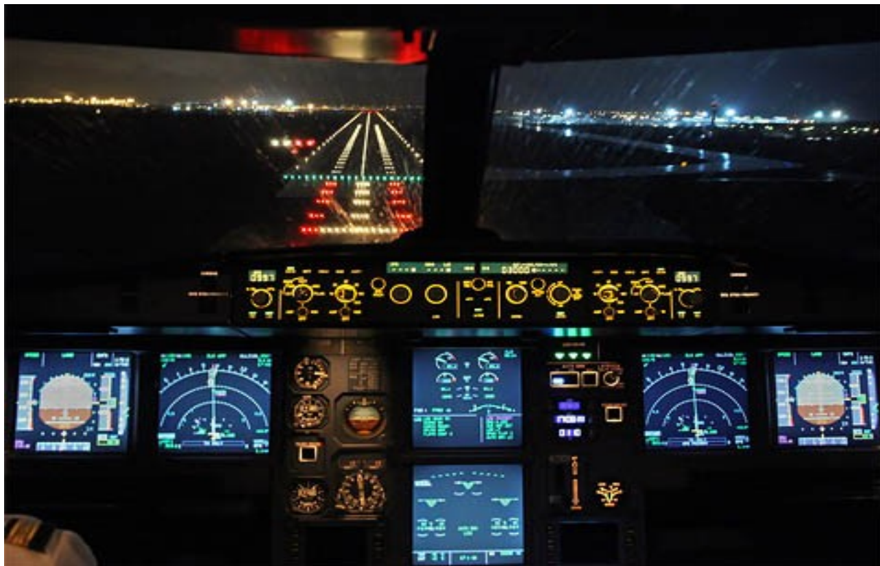
Фигура 1 — Осветление на границата и оста на пистата за излитане и кацане, както се вижда от пилотската кабина на въздухоплавателното средство
