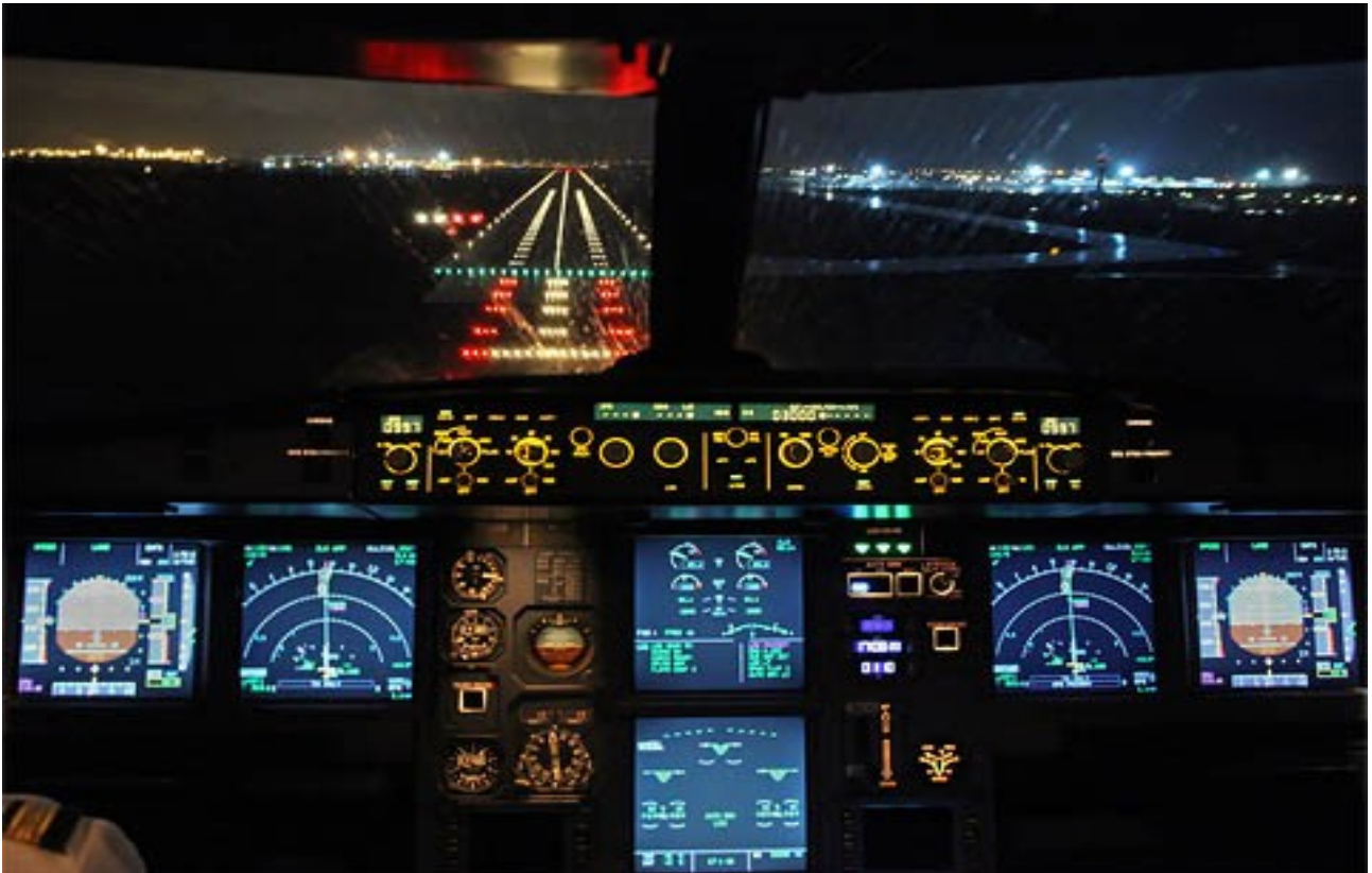
Kuva 1 – Kiitotien reunojen ja keskilinjän merkintävalot ilma-aluksen ohjaamosta katsottuina
