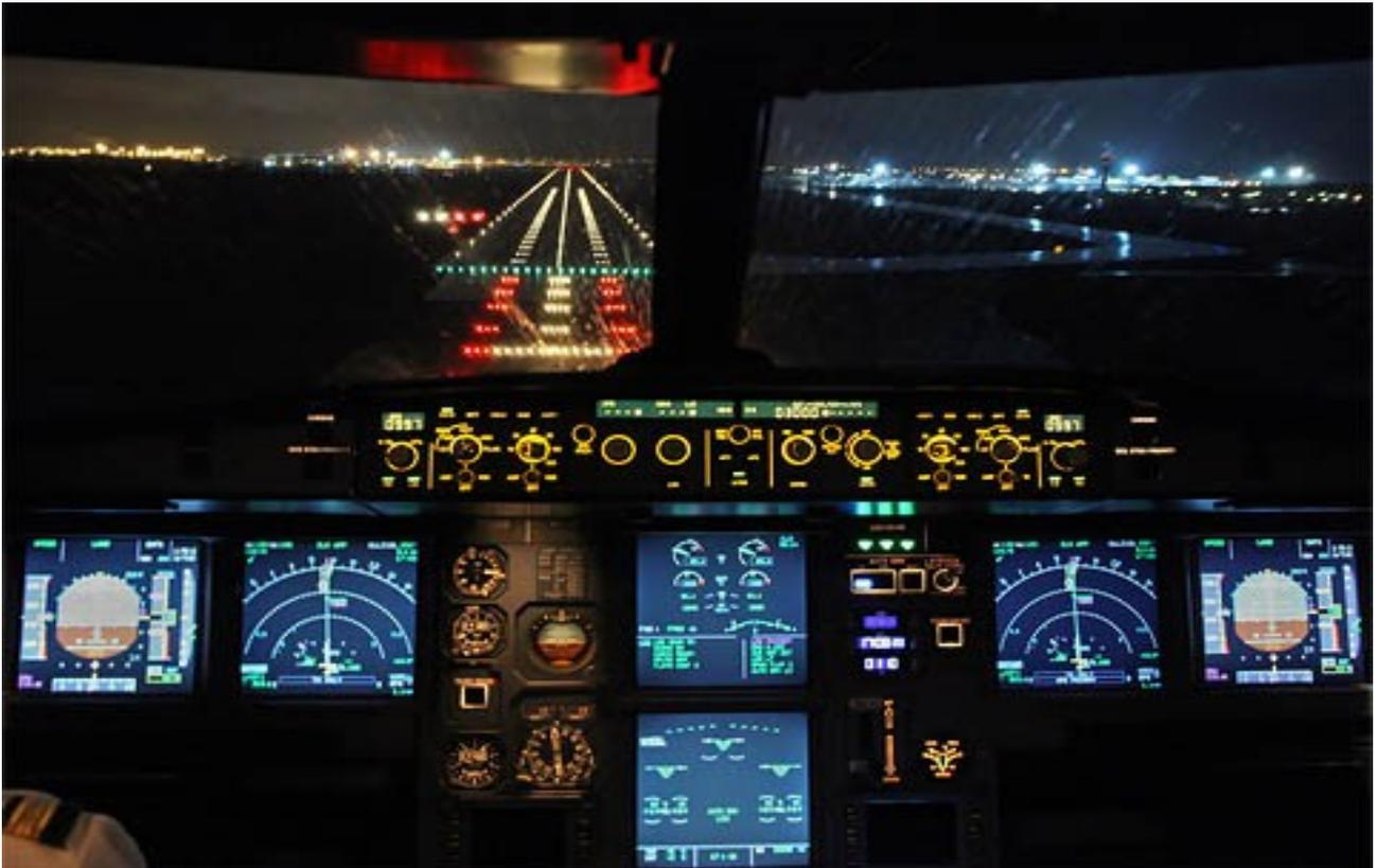
**Figura 1 — Luci di marcatura del bordo e dell'asse della pista viste dalla cabina di pilotaggio dell'aeromobile**
