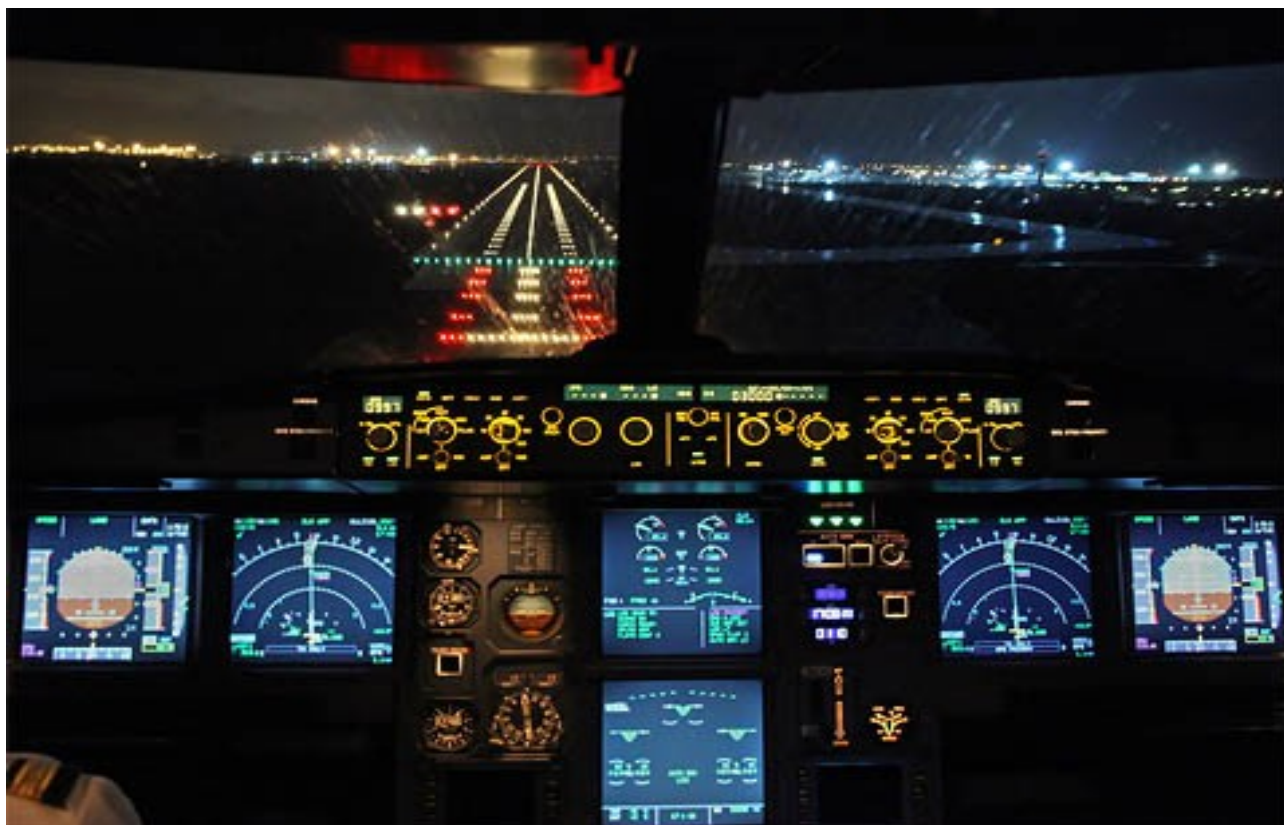
Illustrazzjoni 1 – Il-bordura u d-dwal tal-immarkar tal-assi tar-runway kif jidhru mill-kabina tal-pilota tal-inġenju tal-ajru
