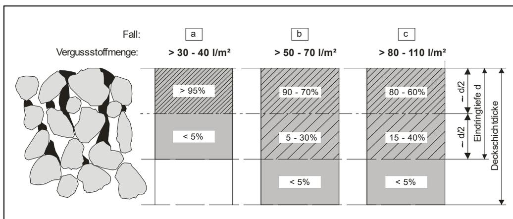
(80) Bei einem Teilverguss darf in keinem Bereich der Deckschicht eine dichte Sperrschicht entstehen. Um eine ausreichende Wasserdurchlässigkeit der Deckschicht zu gewährleisten darf der verbleibende Hohlraumanteil je 5 cm Deckschichthöhe in keiner Lage geringer als 10 Vol.-% sein.
