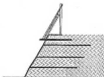
Σύστημα με εσωτερική αυτο-υποστήριξη
