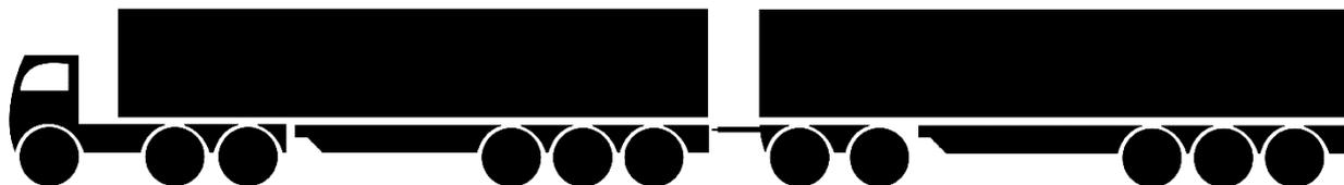
Conjuntos de veículos com reboques duplos do modelo EMS2 A-Duplo, constituídos por camiões, quintas rodas, bonecas e semirreboques. A configuração do eixo pode diferir da ilustração acima.
