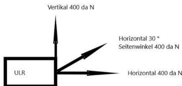
Für die Prüfung der Umlenkrolle werden beide Seilenden (Windenseil und Pilotenseil) durch das Azimutrollensystem in Zugrichtung Pilotenseil geführt und als ein Seil betrachtet.
