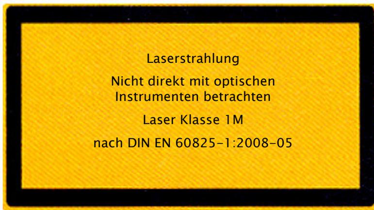
Anmerkung: Der Hersteller kann bei Lasern der Klassen 1 und 1M auf die Kennzeichnung auf den Lasereinrichtungen verzichten und diese Aussagen nur in die Gebrauchsanleitung aufnehmen.
