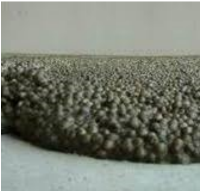
Mortier isolant avec billes de polystyrène expansé
