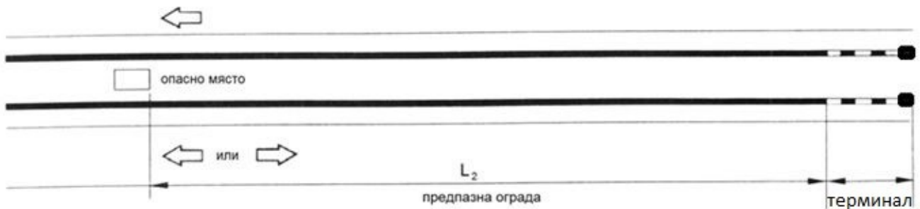
Figure 21: dispositif de retenue construit bilatéralement sur une bande de séparation médiane d'un dispositif de retenue routière à un seul terminal au départ
