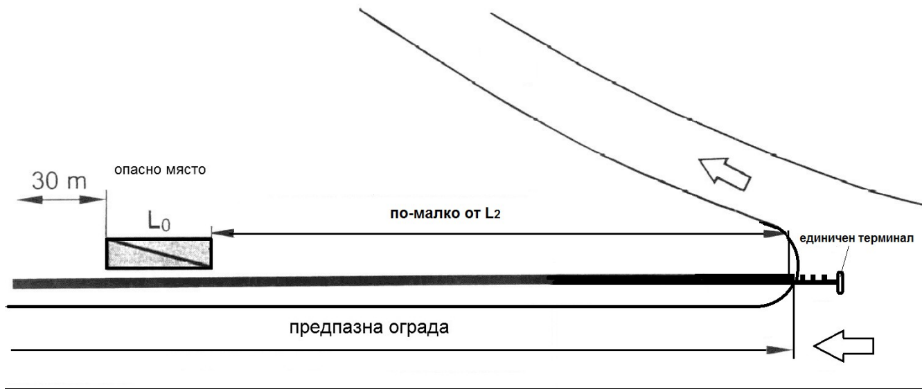
Figure 10: dispositifs de retenue routière avec éléments de départ – mise à zéro à L_2 requis, y compris en cas de fractionnement des flux
