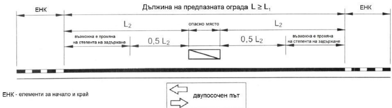
Figure 4: longueur minimale d'un dispositif de retenue routière sur une route bidirectionnelle
