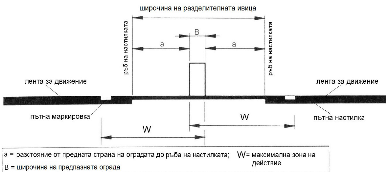
Figure 15: dispositif de retenue routière à deux faces situé dans l’axe de la bande de séparation
