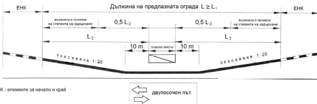
Figure 6: longueur minimale d'un dispositif de retenue routière exécuté par biseautage bilatéral avant et après un emplacement dangereux sur une route bidirectionnelle
