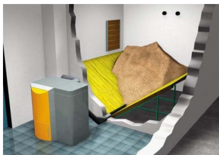
Pelletopslag in een silo met aanzuigsysteem
