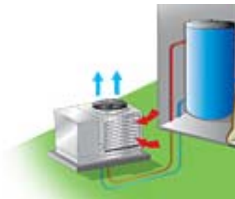
Figuur 191: Schematische voorstelling van een lucht/water koude-opwekker
