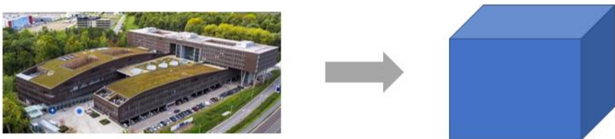
Figuur 4: illustratie van de vereenvoudigde geometrie, complexe vorm van werkelijk gebouw (links) wordt vereenvoudigd naar een kubus.
