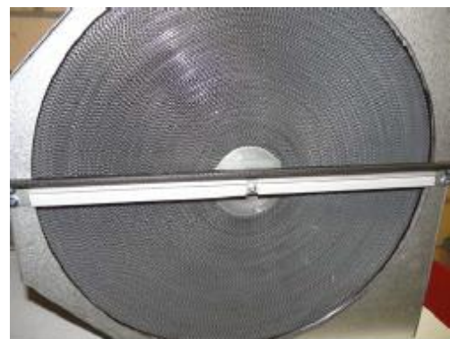
Figuur 52: schema en voorbeeld van een warmtewiel
