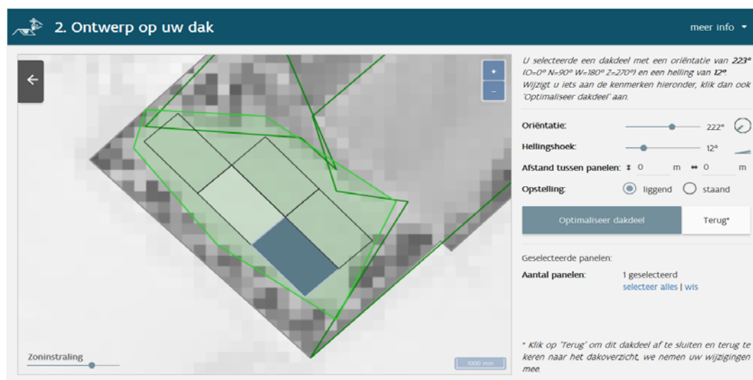
Figuur 234: Aanpassen ontwerp installatie in de zonnekaart en weergeven oriëntatie van de panelen
