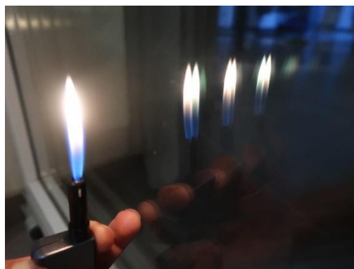
Figuur 122: Driedubbele beglazing
