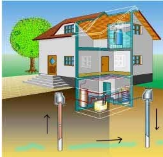
Figuur 192: Schematische voorstelling van een water/water koude-opwekker.
