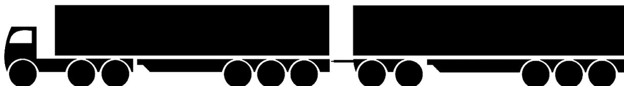
combinazioni di veicoli con rimorchi doppi del tipo EMS2 A-Double costituite da autocarri, ralle, carrelli e semirimorchi. La configurazione dell'asse può differire dall'illustrazione di cui sopra.
