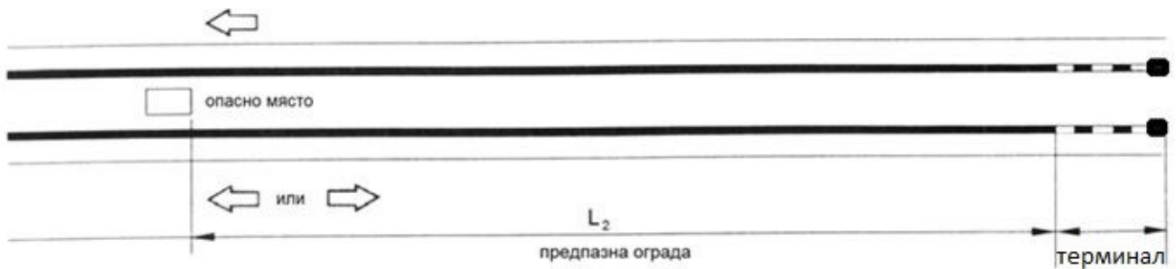
Abbildung 21. Bilateral aufgebautes Rückhaltesystem in einem Mitteltrennstreifen des einseitigen Fahrzeugrückhaltesystems mit Einzelterminals als Anfang
