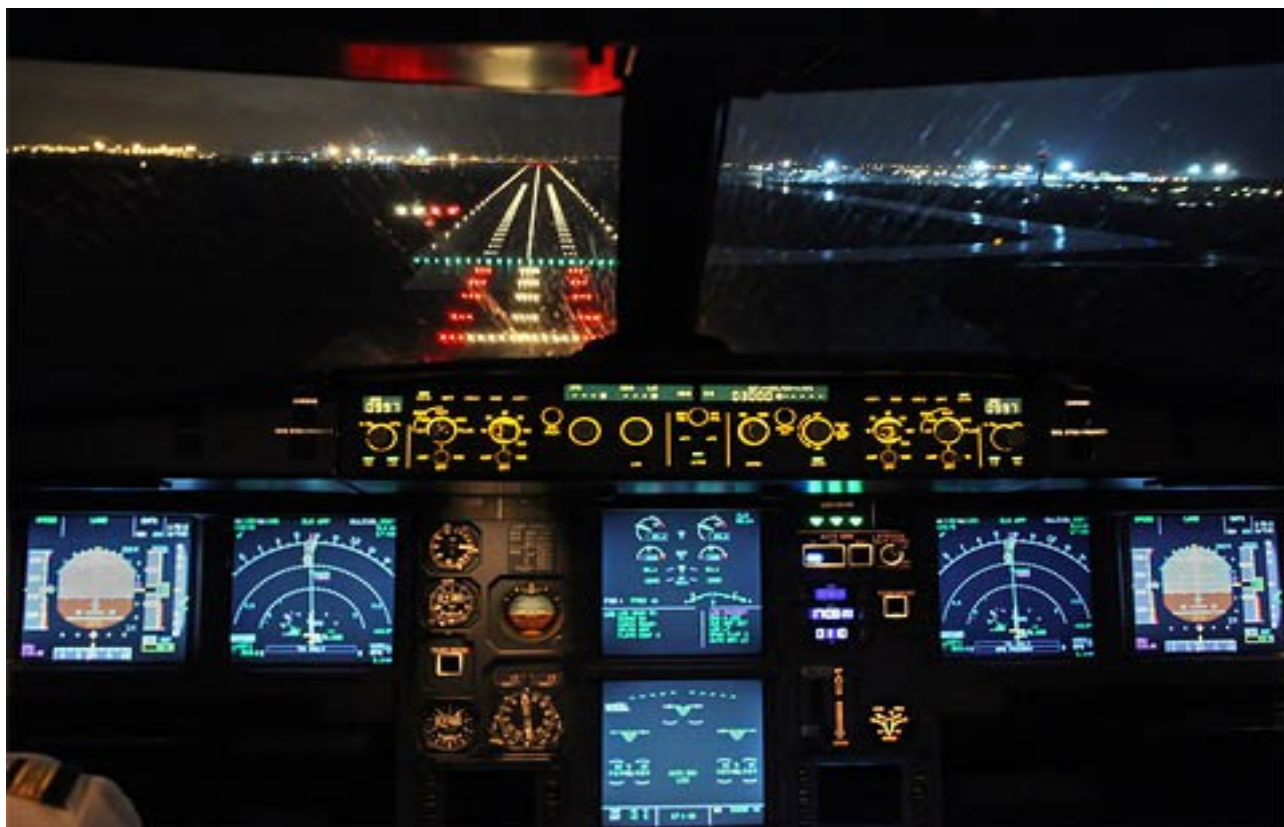
Figura 1 – Luminile de marcare a frontierei și a axei pistei, așa cum sunt văzute din cabina de pilotaj a aeronavei
