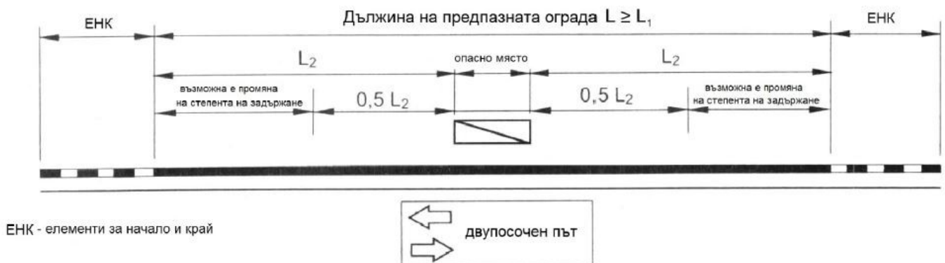
Фигура 4. Минимална дължина на ограничителна система за пътища при двупосочен път
