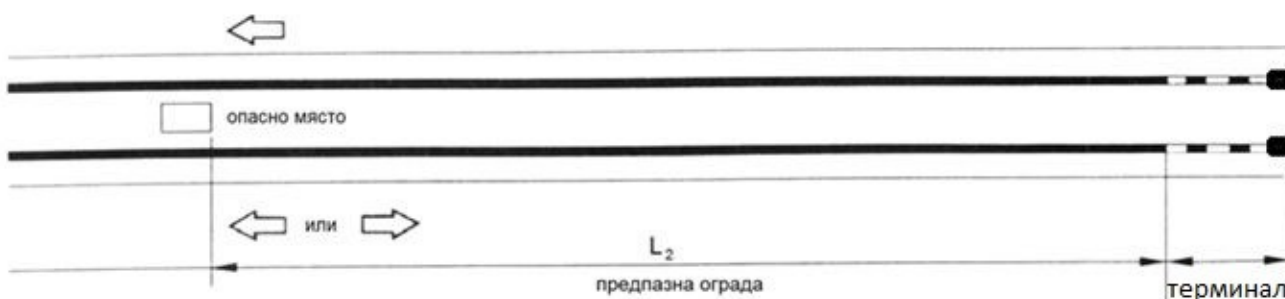
Фигура 21. Ограничителна система изградена двустранно в разделителна ивица от едностранна ограничителна система за пътища с единични терминали за начало
