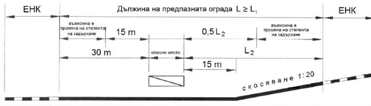
Фигура 6. Минимална дължина на ограничителна система за пътища изпълнена чрез двустранно скосяване преди и след опасно място при двупосочен път
