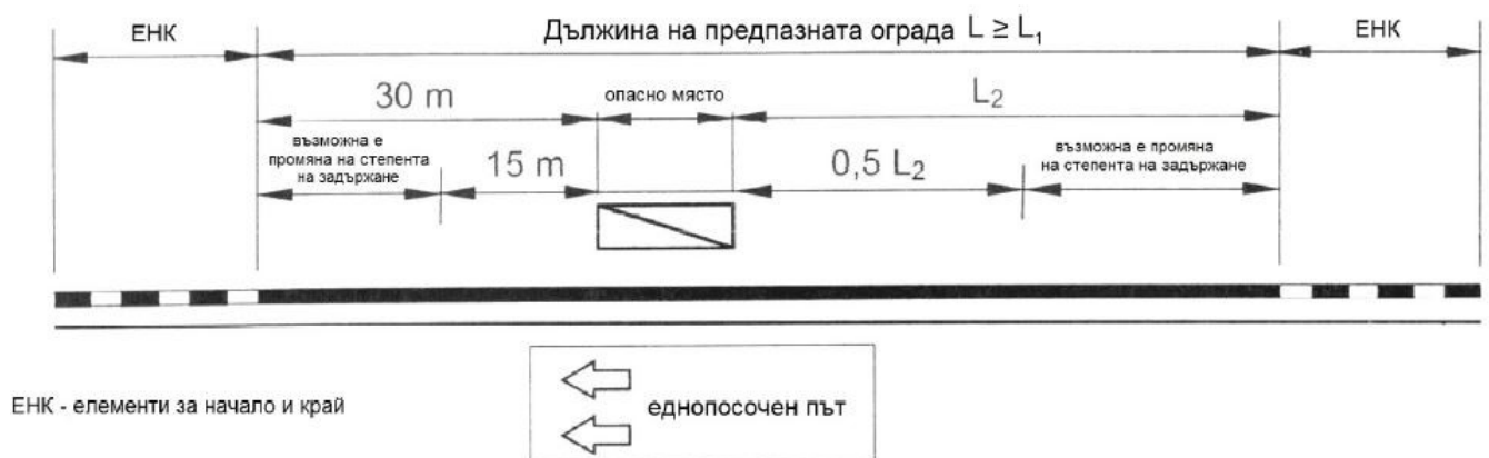
Фигура 5. Минимална дължина на ограничителна система за пътища при еднопосочен път
