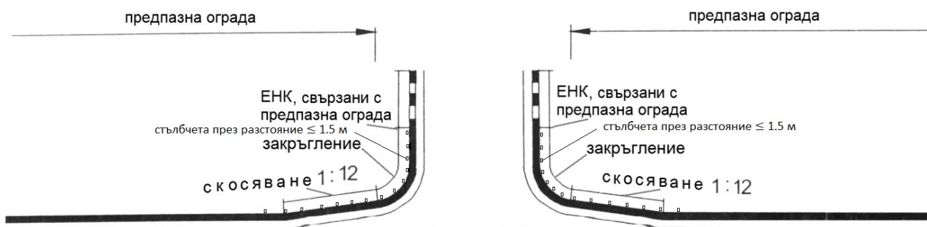
Фигура 9в Прекъсване на предпазната ограда скосена навън 1:12, закръгления и ЕНК
