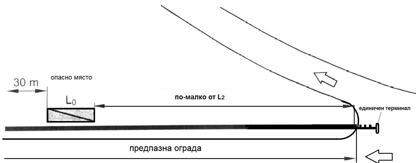
Фигура 11. Ограничителна система за пътища с елементи за начало – единичен терминал при недостатъчно L_2 , включително при разделяне на потоци
