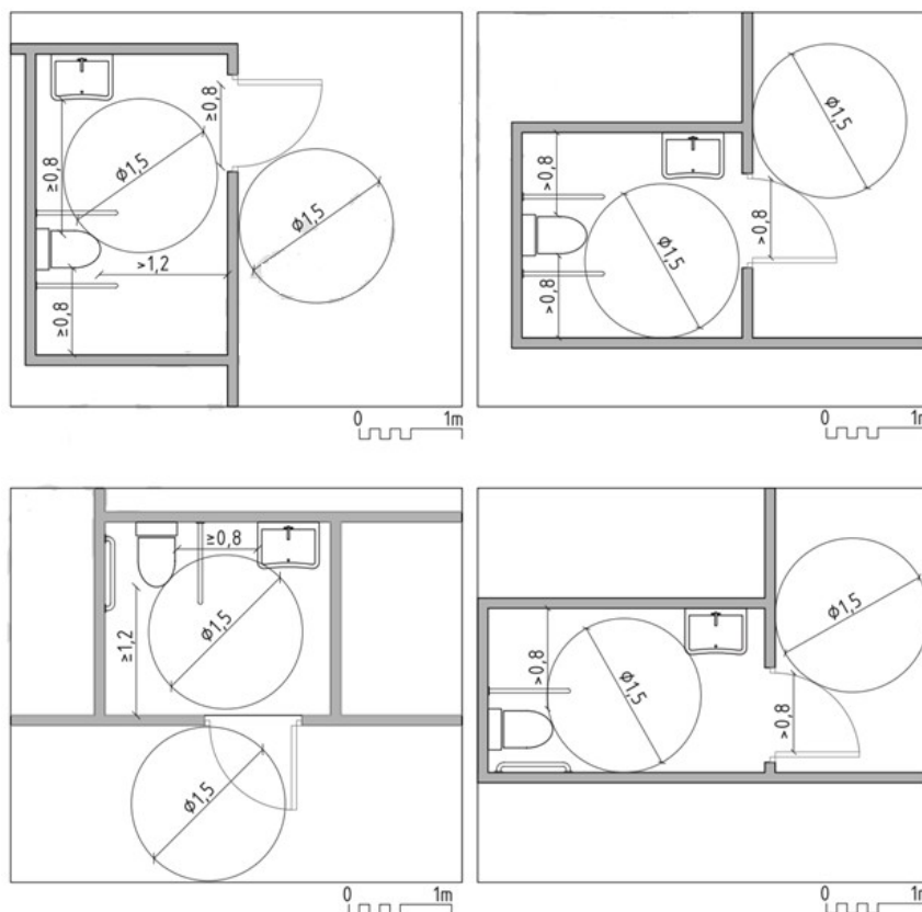
Figura 78 Exemple de soluții pentru toalete accesibile
