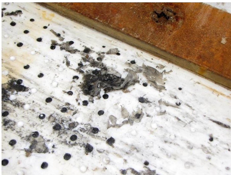
Slika 195: Struženje površine teflonskega diska.
