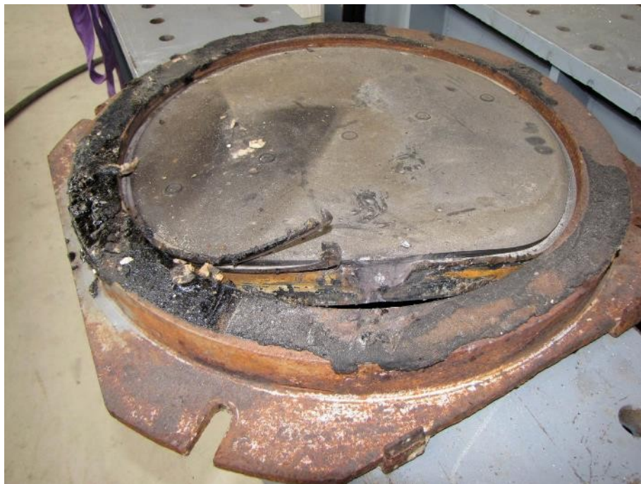
Slika 189: Poškodovana elastomerna blazina na mestu iztiskanja. Notranje tesnilo je iz teflona.
