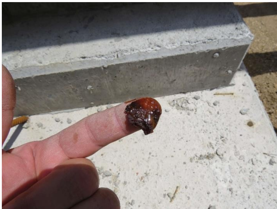
Slika 170: Neustrezno zreagiranje epoksidnega lepila, ki zato deluje kot mazivo v stiku.
