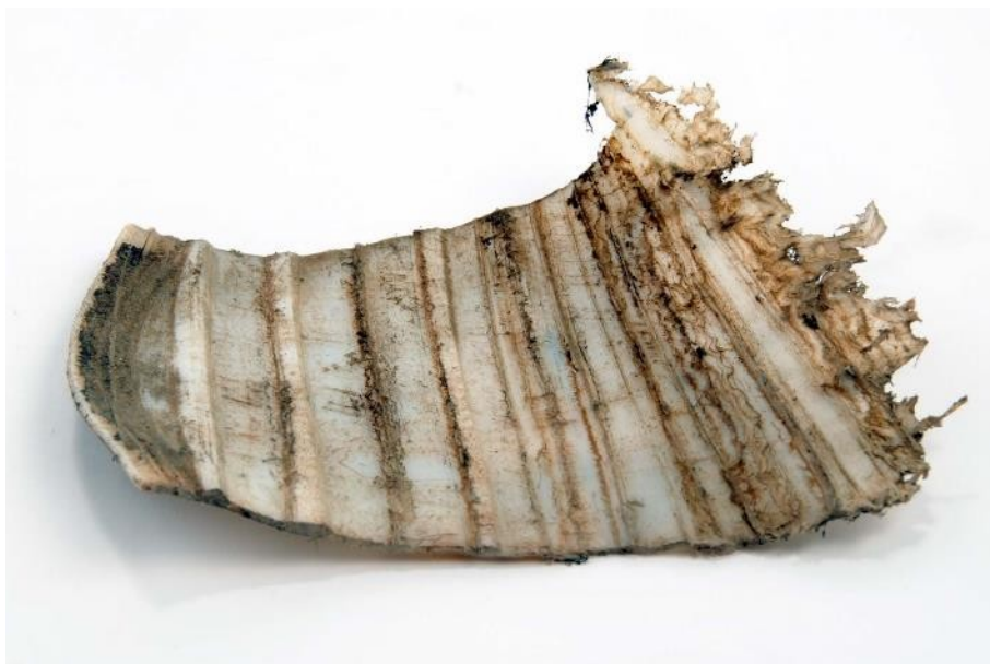
Slika 183: Del iztisnjenega teflonskega diska (po demontaži ležišča).
