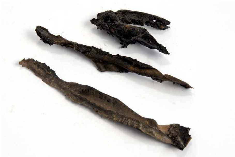
Slika 187: Iztisnjeni ostanki elastomerne blazine.
