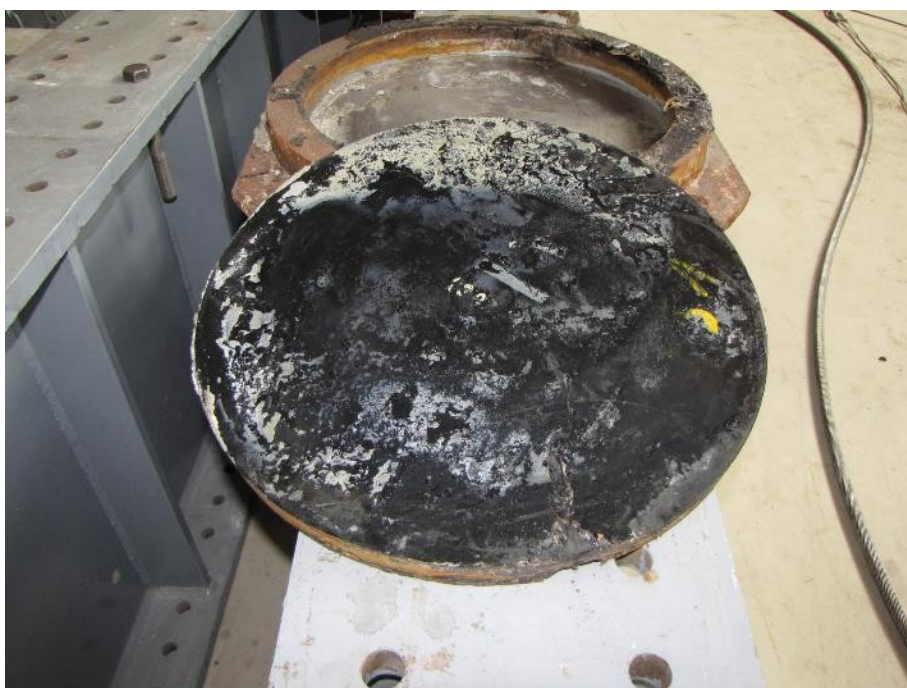
Slika 191: Kontaktna površina elastomerne blazine z dnom lonca.
