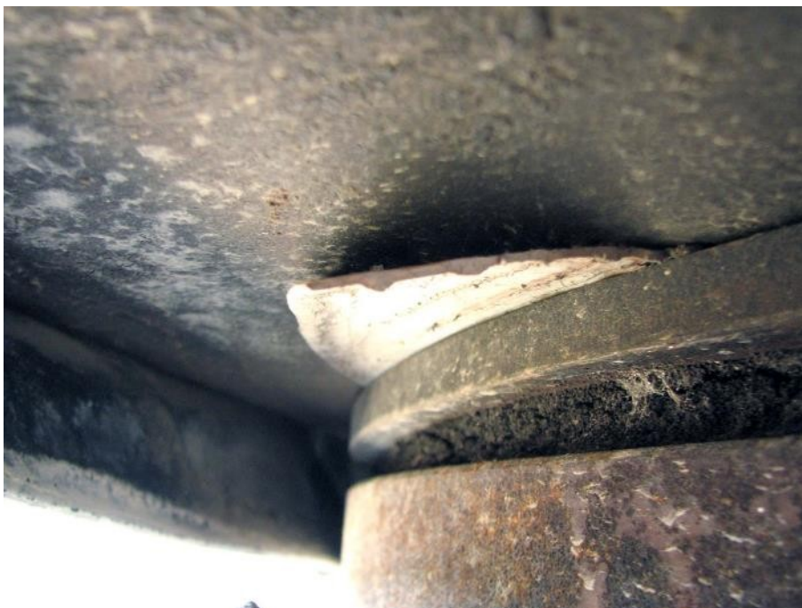
Slika 182: Iztiskanje teflonskega diska iz ohišja batnice.
