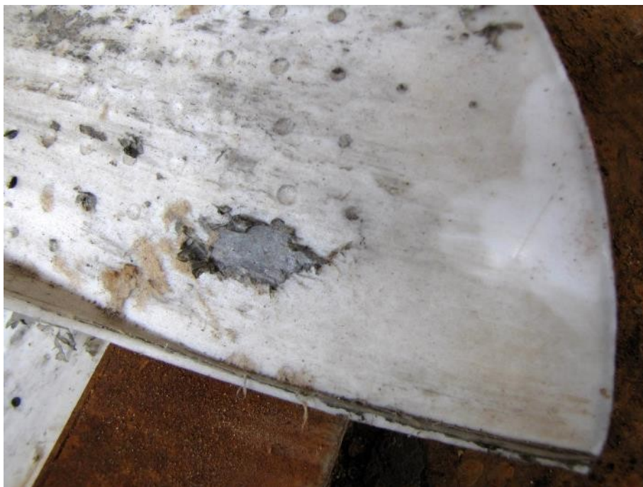
Slika 196: Obraba površine teflonskega diska v območju roba utora batnice in centralnega vodila.
