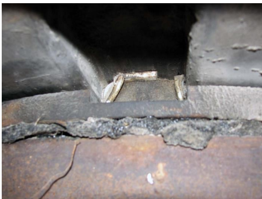
Slika 184: Iztiskanje teflonskega diska iz batnice v utor vzdolžnega vodila.
