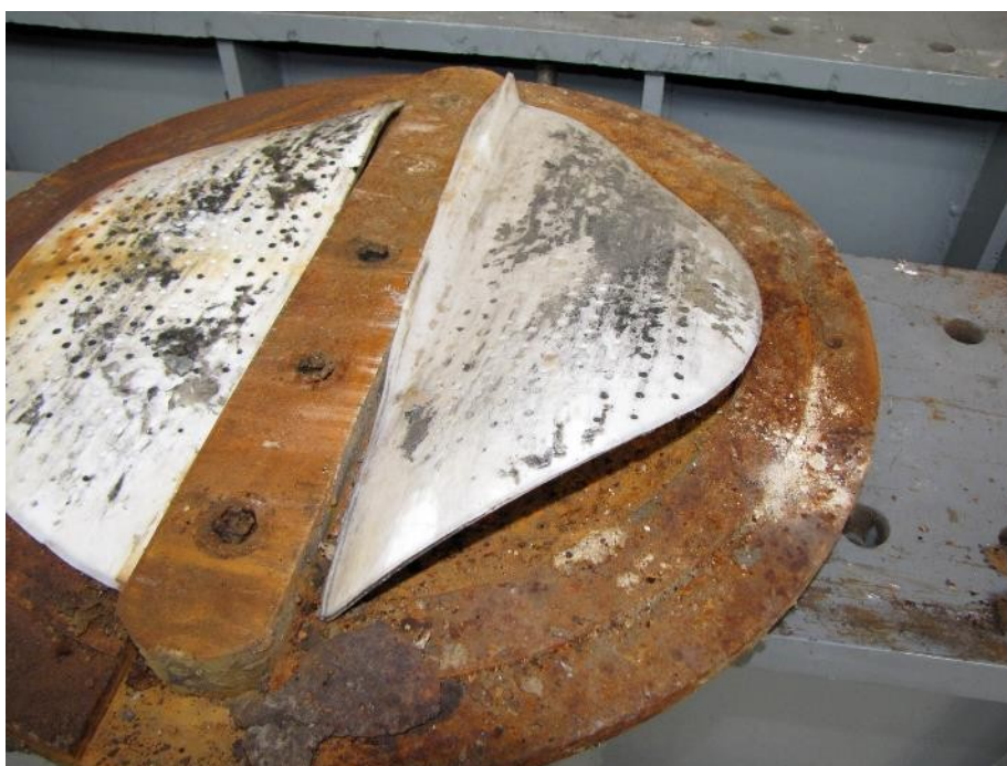
Slika 193: Nepravilno usmerjenost žepkov teflonskega diska na batnici lončnega ležišča. Deformirani teflonski disk zaradi iztiskanja v področje vzdolžnega utora.
