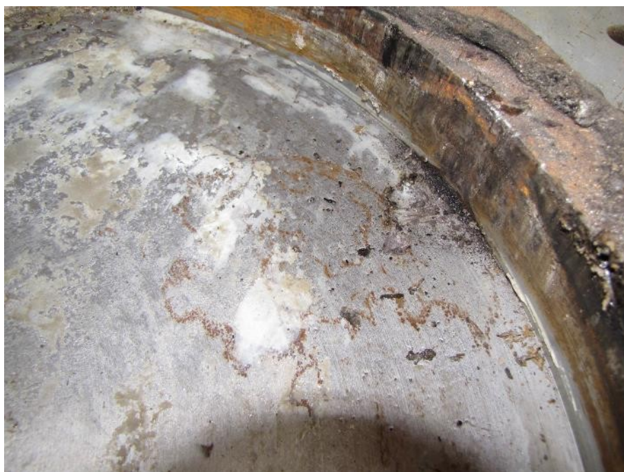
Slika 192: Dno in obod lonca na mestu iztiskanja elastomerne blazine.
