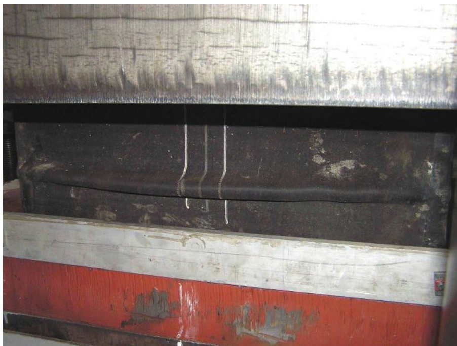
Slika 127: Lokalno izrazita guba zaradi napake med procesom vulkanizacije.
