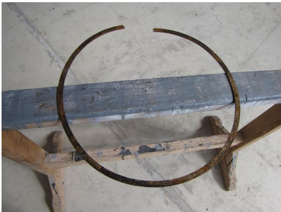
Slika 202: Medeninasto notranje tesnilo elastomerne blazine lončnega ležišča.
