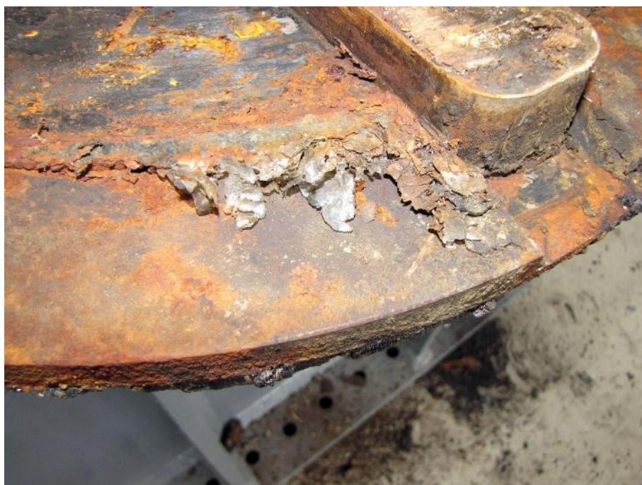
Slika 201: Ostanke ostružkov teflonskega diska na robu utora batnice.
