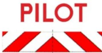
Fig. 1 Modelo de marcado del capó del vehículo.
