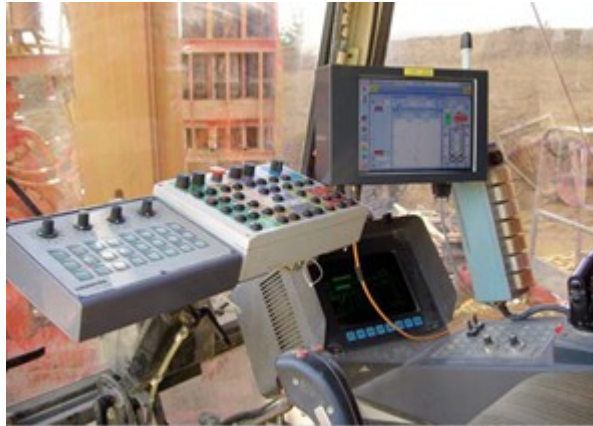
Εικόνα 4 - Ηλεκτρονικό σύστημα ελέγχου υδροφρέζας, με δυνατότητα περιορισμού των ανοχών κατακορύφωσης στο 0,3%
