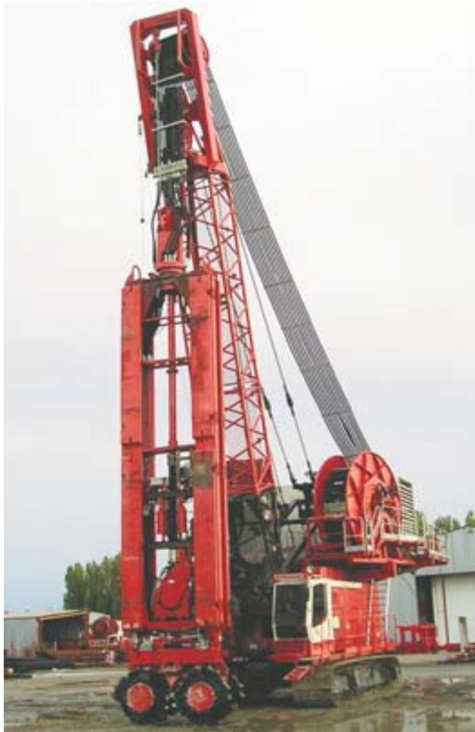
Figura 2 — Cortador de hidrofresas
