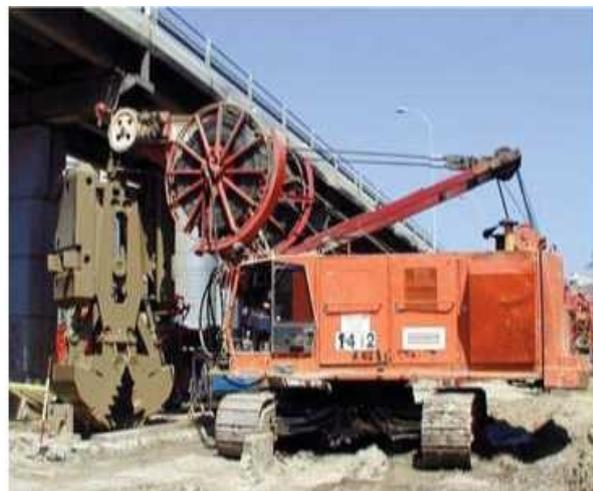
Figura 3 — Cucharas de cable de acero que funcionan mecánicamente (benes)
