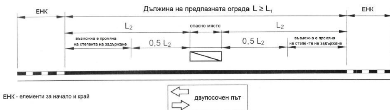
Abbildung 4. Mindestlänge eines Fahrzeugrückhaltesystems auf einer Zweibahnstraße
