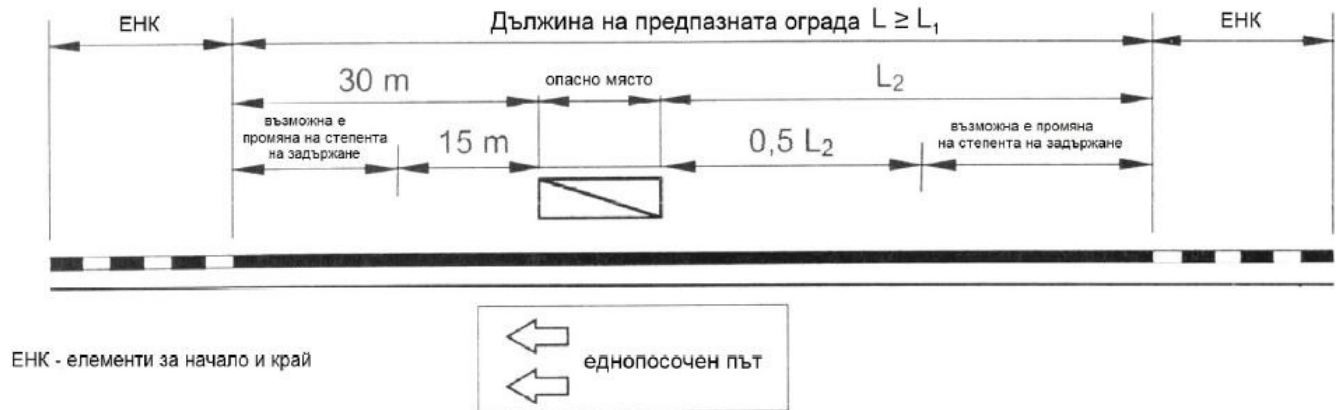
Abbildung 5. Mindestlänge eines Fahrzeugrückhaltesystems auf einer Einbahnstraße
