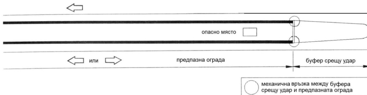
Abbildung 20. Bilateral aufgebautes Rückhaltesystem in einem Mittelstreifen des einseitigen Fahrzeugrückhaltesystems mit Anpralldämpfern als Anfang
