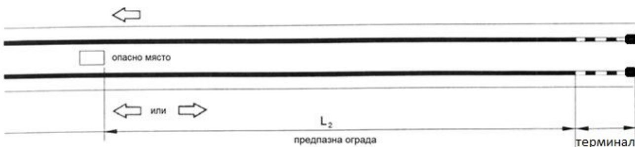
Abbildung 21. Bilateral aufgebautes Rückhaltesystem in einem Mittelstreifen des einseitigen Fahrzeugrückhaltesystems mit Einzelterminals als Anfang
