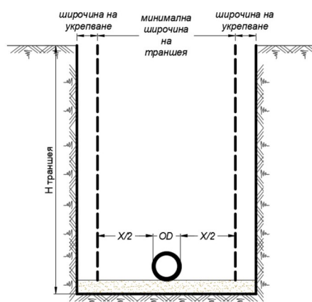
«Figura 2. Zanja fortificada
