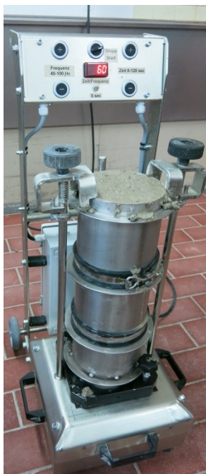
Figure 3: Compacteur avec forme cylindrique serrée et remplie de béton
