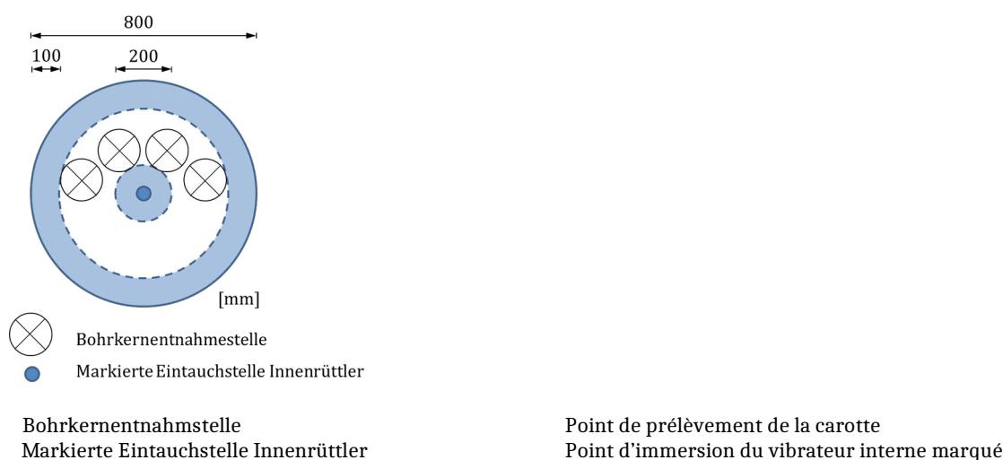
Figure 7: Recommandation pour les points de prélèvement des carottes sur le petit composant (vue de dessus)
