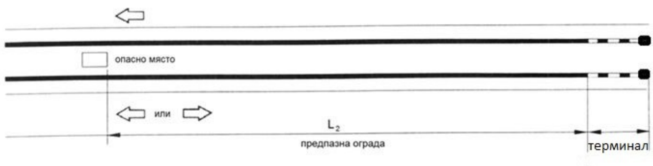
Figure 21. Dispositif de retenue construit bilatéralement sur une bande de séparation médiane d'un dispositif de retenue routier à un seul terminal au départ
