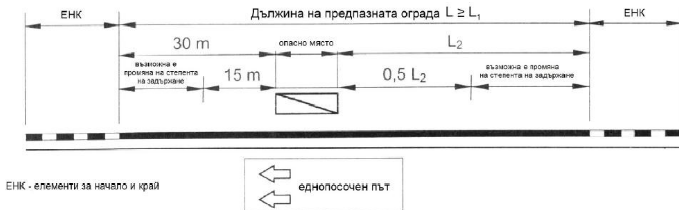
Figure 5. Longueur minimale d'un dispositif de retenue routier sur une route à sens unique
