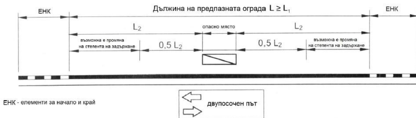
Figure 4. Longueur minimale d'un dispositif de retenue routier sur une route bidirectionnelle
