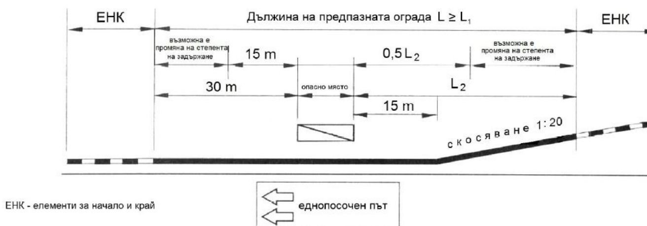
Figure 7. Longueur minimale de la barrière de sécurité en cas de biseautage unilatéral avant un emplacement dangereux sur une route à sens unique
