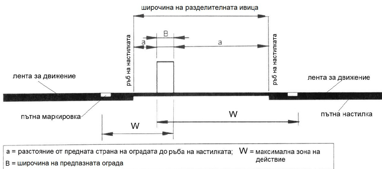
Figure 16. Dispositif de retenue routier bilatéral situé sur les côtés de l'axe de la ligne de séparation
