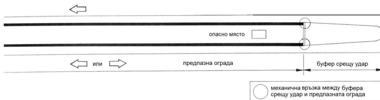
Figure 20. Dispositif de retenue construit bilatéralement sur la bande médiane de séparation du dispositif de retenue routier unilatéral avec un amortisseur au départ
