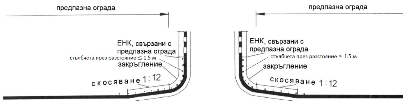
Figure 9c Interruption d'une barrière de sécurité biseautée vers l'extérieur à 1:12, arrondis et EIF
