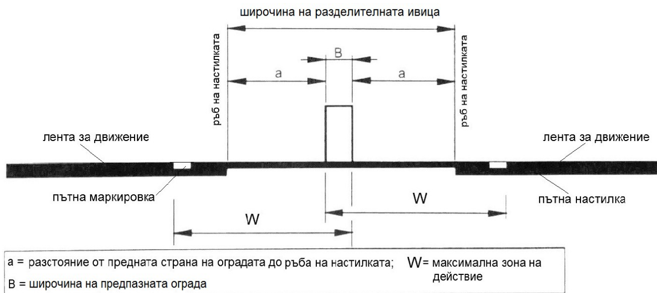
Figure 15. Dispositif de retenue routier à deux faces situé dans l'axe de la bande de séparation
