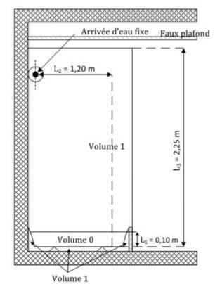
Volume Volume Faux plafond False ceiling Arrivée d'eau fixe Fixed water inlet
