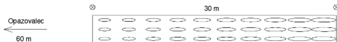
Slika 44: Velikost površine merilnih točk pri meritvi svetlosti z ustreznim inštrumentom
