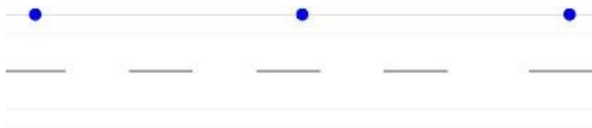
Slika 7: Enostranska namestitev svetilk
