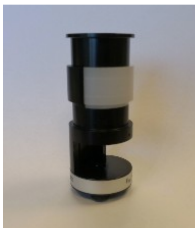
Slika 49: Merilnik za merjenje polcilindrične osvetljenosti
