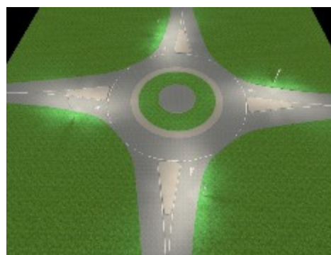
Slika 34: Primer postavitve svetilk za osvetlitev krožnega križišča brez prehodov za pešce
