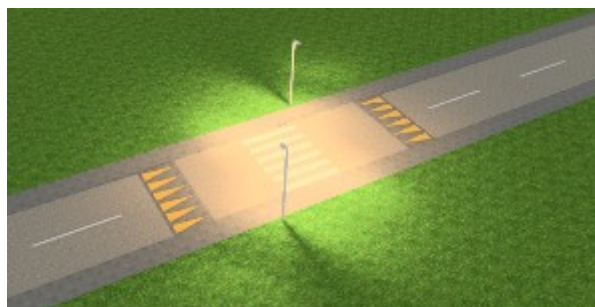
Slika 39: Primer postavitve svetilk za osvetlitev ploščadi trapezne oblike s prehodom za pešce na neobremenjenem delu ceste znotraj naselja
