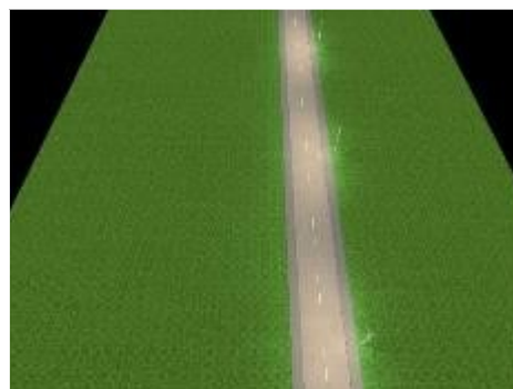
Slika 14: Primer postavitve svetilk na eni strani ceste za osvetlitev vozišča in površin za pešce na obremenjenem delu ceste v naselju
