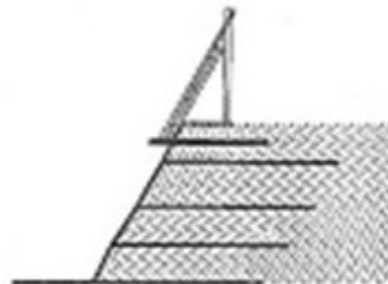
Σύστημα με εσωτερική αυτο-υποστήριξη
